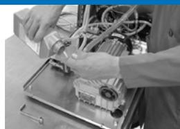
Abasteça a bomba de vácuo com o óleo fornecido até o centro do óculo de inspeção do óleo. O nível de óleo situa-se sensivelmente no centro do óculo de inspeção no ponto de rotação da caixa.
